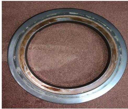
**Figure IV.22 : Grain mobile de garniture mécanique usé.**
