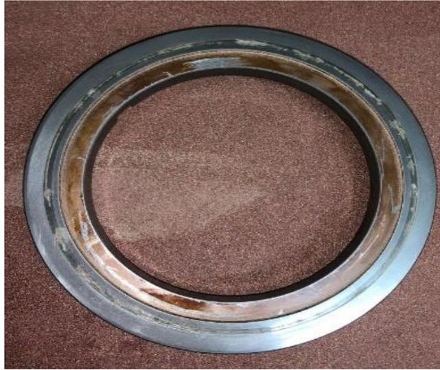
**Figure IV.11 : Grain mobile de garniture mécanique**
