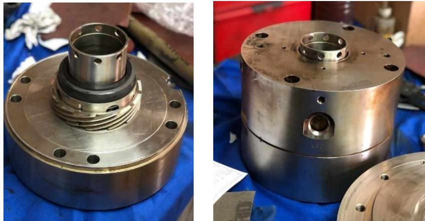
Figure IV.17 : Garniture mécanique de pompe P025 avant et après le montage
