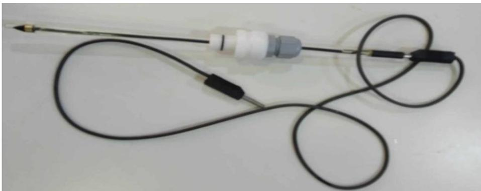
**Figure II.15.** Contre électrode
