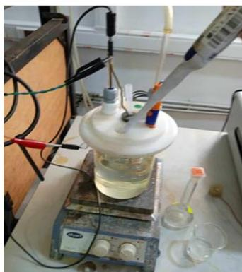
**Figure II.19.** Opération d'injection d'inhibiteur par micro pipette
