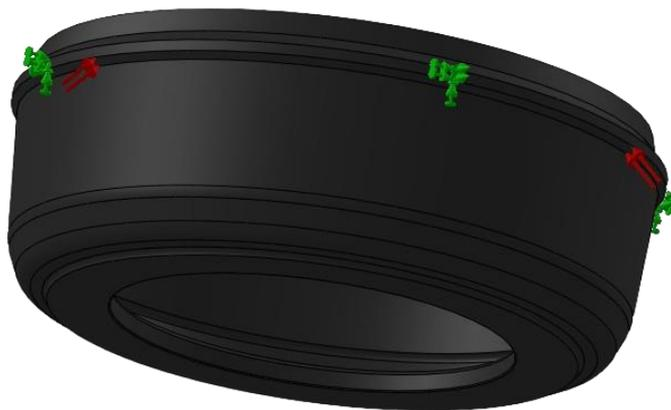
**Figure III.1** : Tambour sous charge répartie et conditions aux limites.
