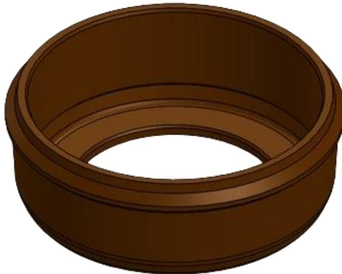
**Figure II.3:** Tambour de frein brut dessiné par SolidWorks®.
