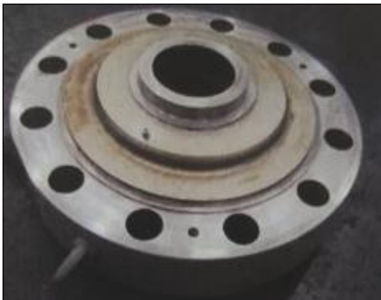
Figure III 7 Couvercle de pompe [10]
