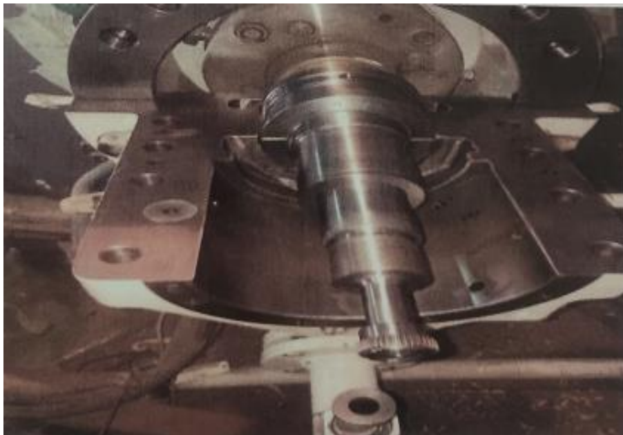
Figure III 8 Arbre de pompe
