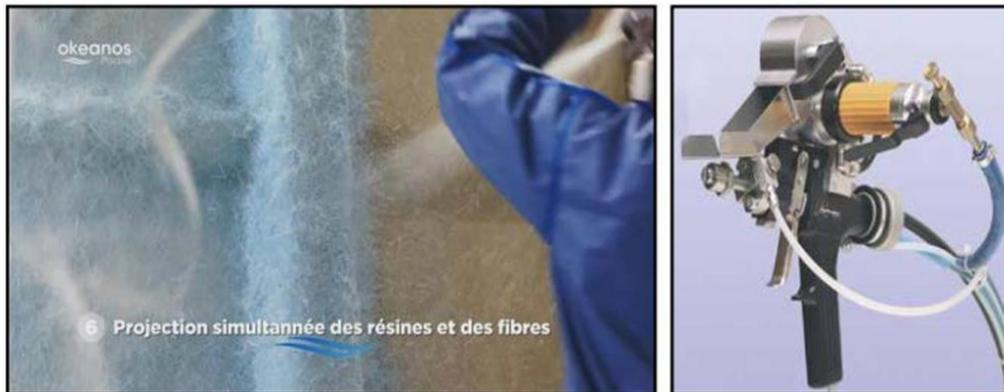
**Fig.I.12.** Principe du moulage par projection simultanée (Source Okeanos-France
