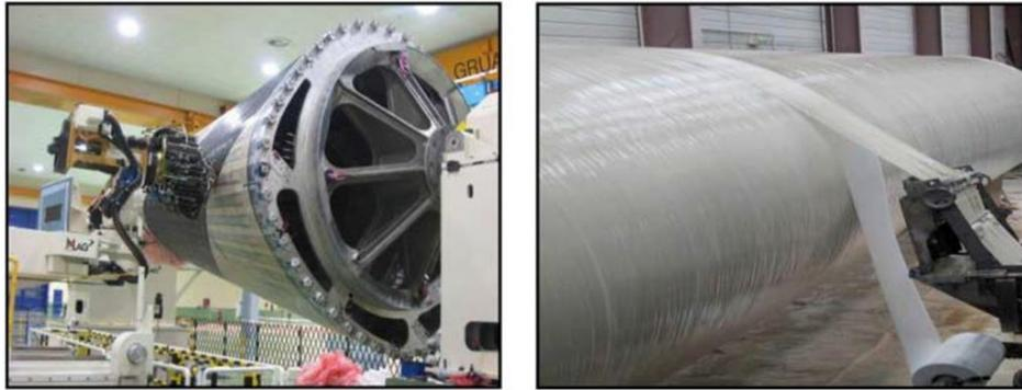
**Fig.I.20.** Principe du moulage par enroulement filamentaire (source site CNES)
