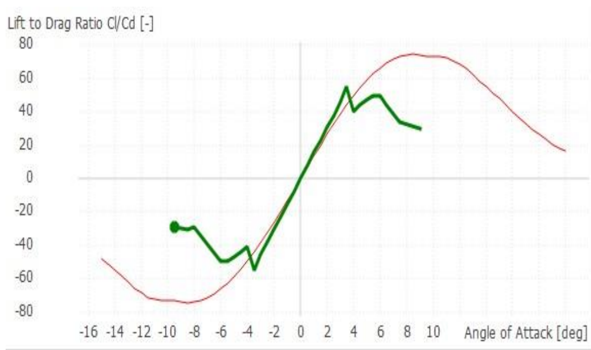
Figure 38 : Ratio du coefficient de portance et du coefficient de trainée [ C_l/C_d ] par rapport à l'angle d'attaque [ \alpha ]
