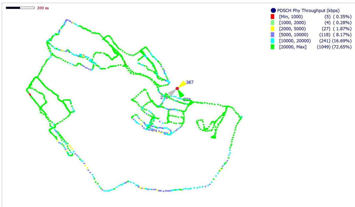
Figure 4. 18 : Résultats du Débit DL avant l'implémentation d'IMB
