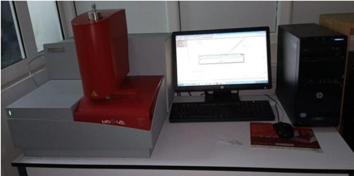
**Figure N° V . 3 :** Calorimètre DSC, de type Labsys Evo, Setaram.
