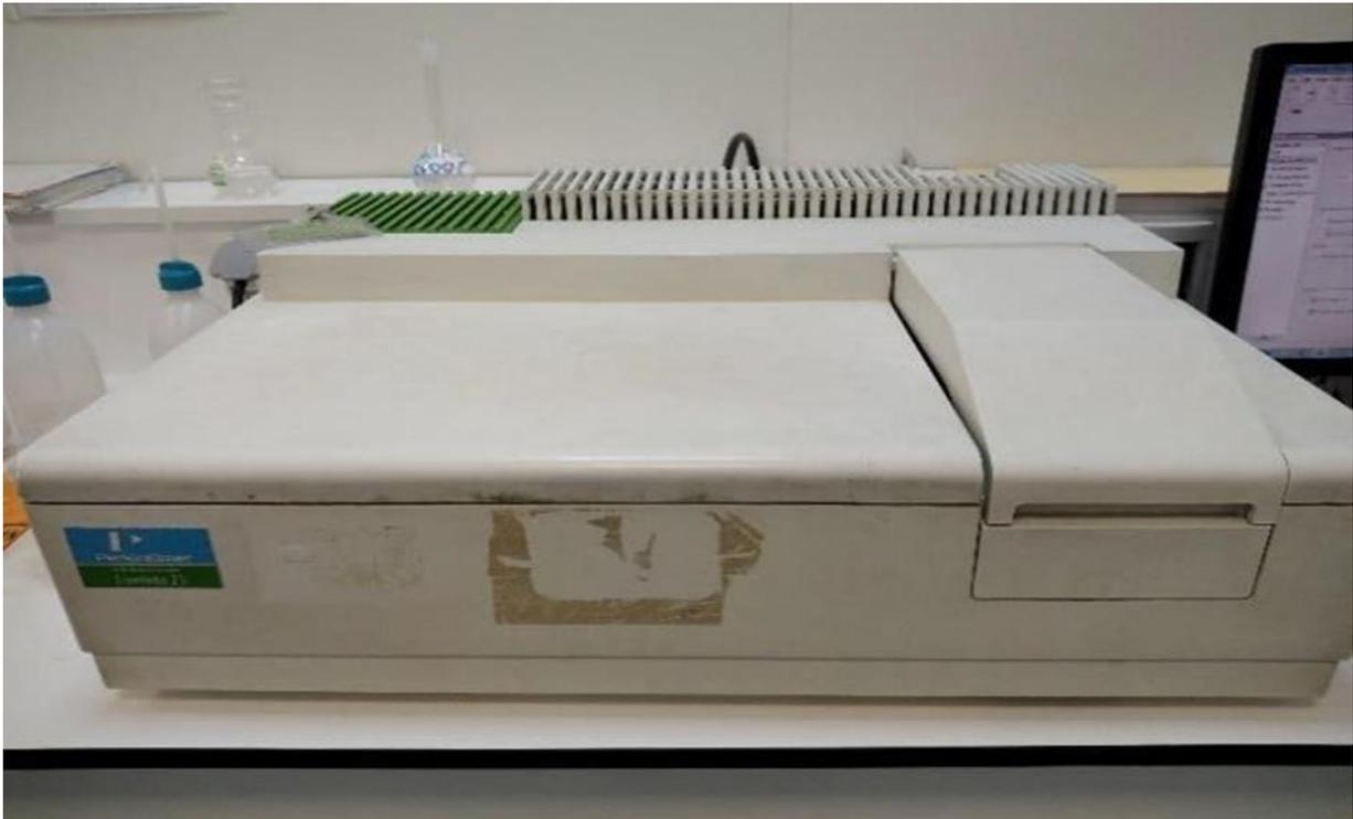
Figure N° V . 2 : Un spectrophotomètre UV/visible Perkin Elmer \_ Lambda 25.
