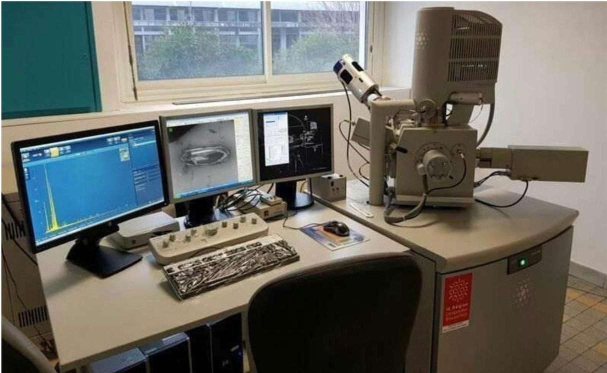
**Figure N° V.4 :** Microscope électronique à balayage, FEI Quanta 650FEG.
