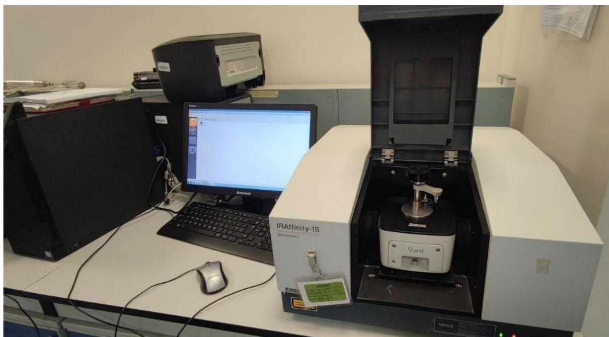
Figure N° V . 1 : Le spectromètre infra-rouge IRTF, IR Aftinity-1S.
