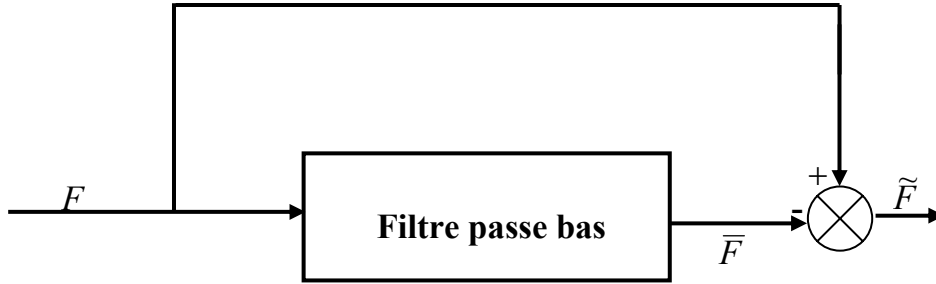
Fig. II.5 : Principe de séparation des composantes alternatives de puissances
