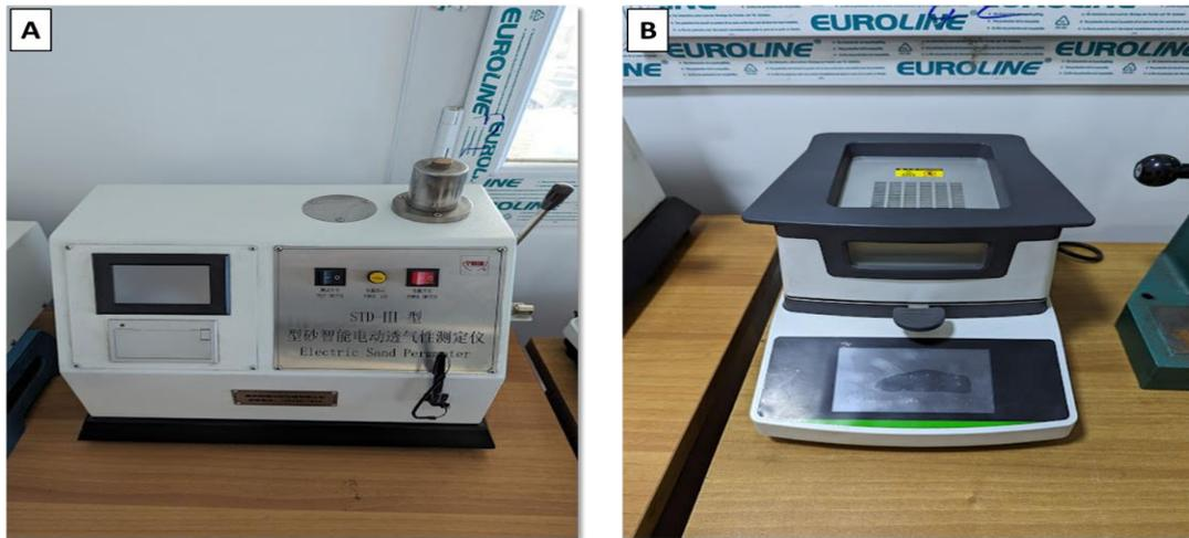
Figure II-16 : (A) Appareil de contrôle de perméabilité, (B) Appareil de contrôle d'humidité.
