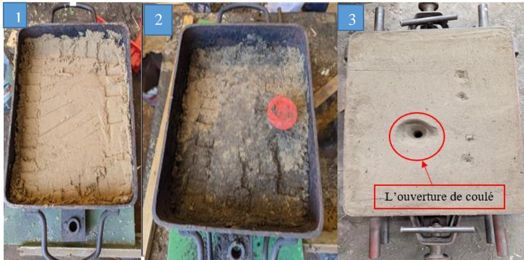
Figure II-18 : (1,2) Châssis inférieur et supérieur, (3) Châssis final.
