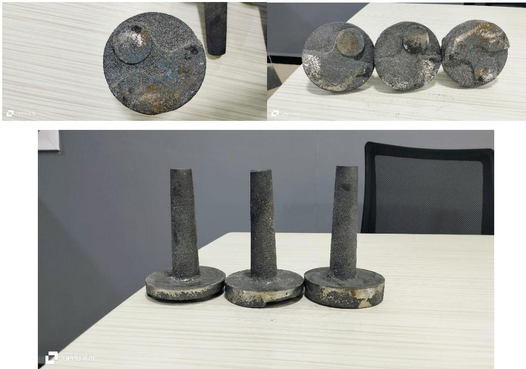
Figure III-5 Vilebrequin réalisé.
