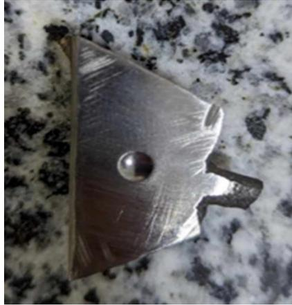
**Figure III-7 :** Résultat de l'essai de dureté.
