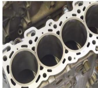
*Figure I-7: Blocs moteurs.*
