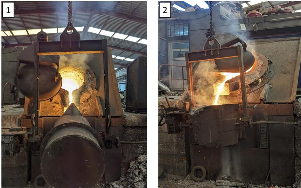
Figure II-25 : (1) et (2) Coulage dans la poche de traitement de sphéroïdisation au Mg.
