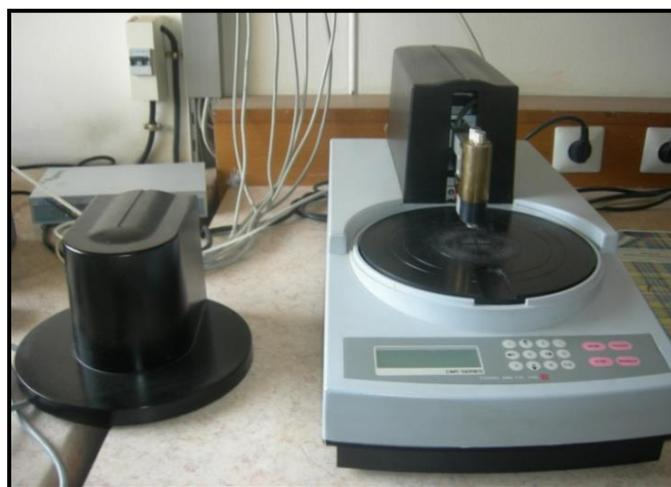
**Figure (II.20):** Photographie du dispositif de mesure de la résistance carrée.
