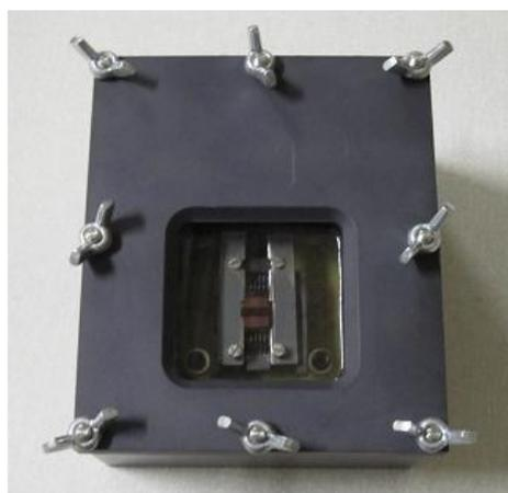
**Figure (II.13):** Boîtier de l'emplacement des cellules à caractérisé.
