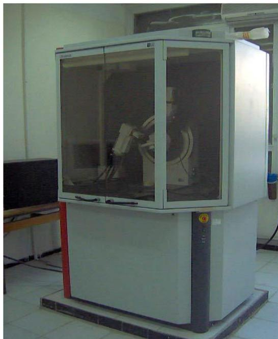
**Figure (II.18):** *Dispositif expérimental de caractérisation structurale (DRX) utilisé.*
