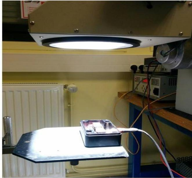
Figure (II.14): Banc de caractérisation  $J(V)$  des cellules solaires élaborées
