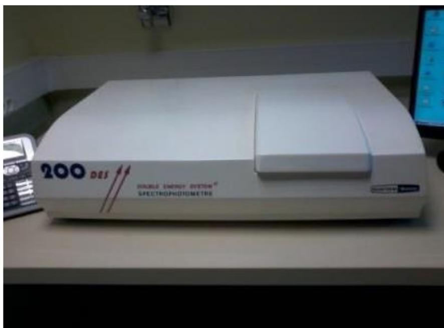
Figure (II.22): Spectrophotomètre de type (SAFAS 200 DES) utilisé.
