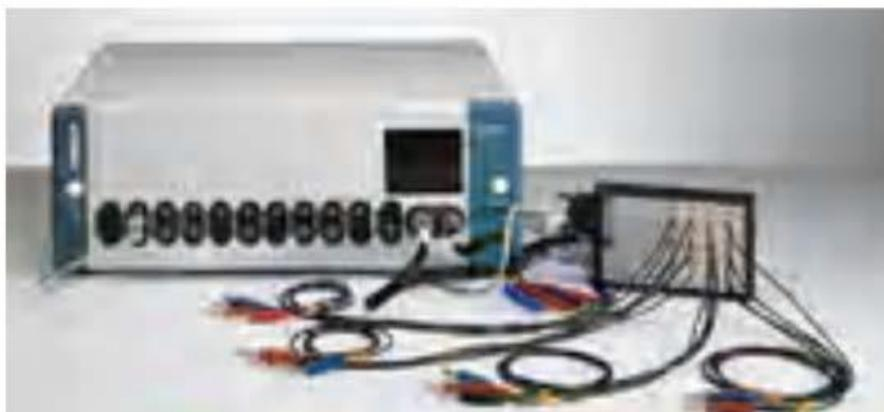
**Figure (II.3):** *Dispositif expérimental utilisé pour le tracé des courbes d'impédance électrochimique (AUTOLAB).*
