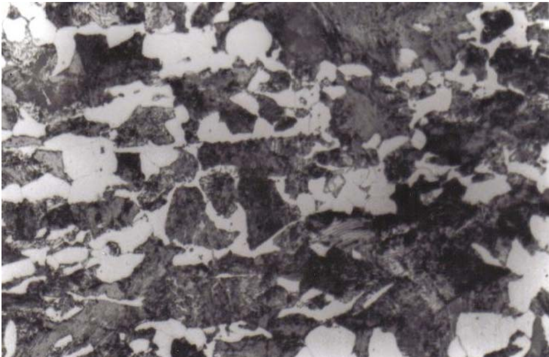
Figure 2.1. Aspect microstructural révélé par une attaque au Nital 3 %, Grossissement 1000, de l'acier au carbone de nuance N 80.
