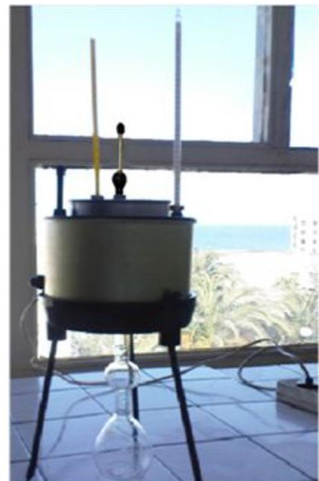
Fig. 16: Viscosimètre Engler
