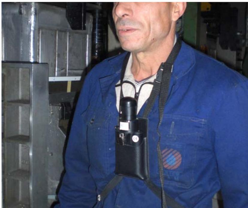
**Fig. V.7:** Injecteur des cuves équipé du CIP 10.
