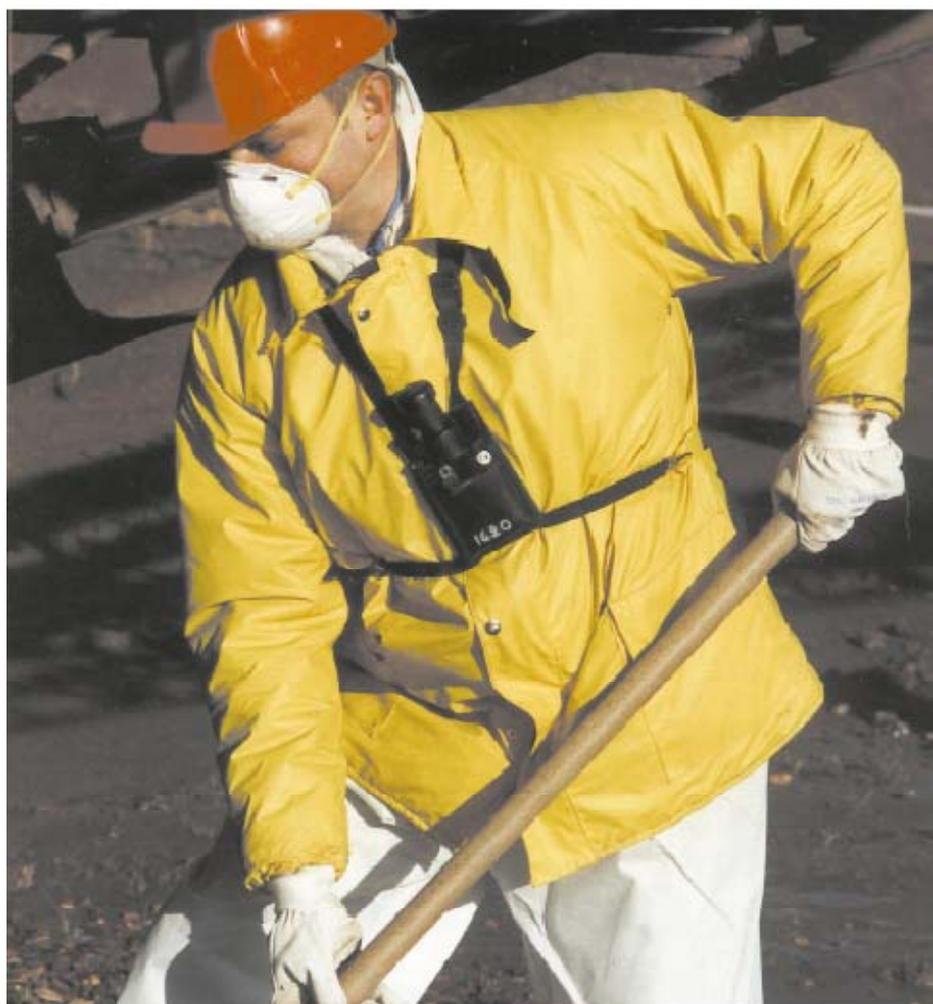
Figure .IV.11 : Schéma du CIP 10 porté par un travailleur [165]
