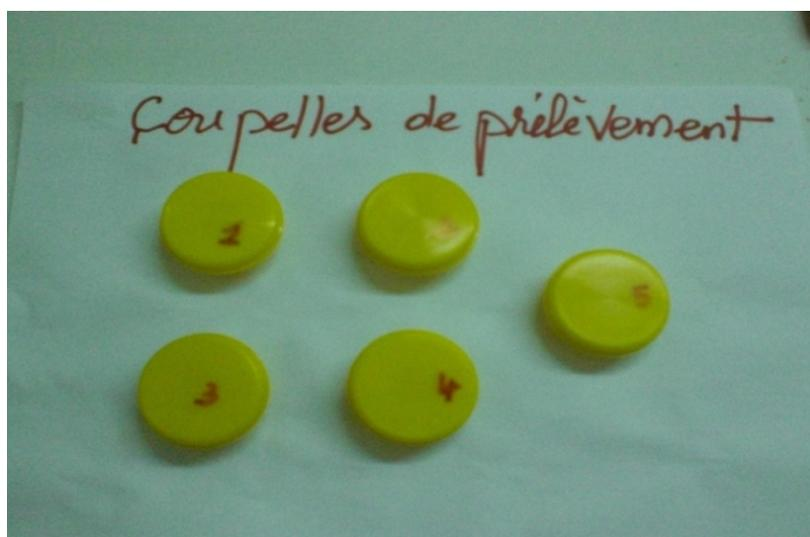
Fig. V.1 : Coupelles rotatives pour prélèvement des poussières.
