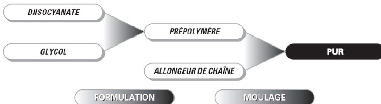
Fig. II.1 : schéma de réalisation de la mousse de polyuréthane [76].
