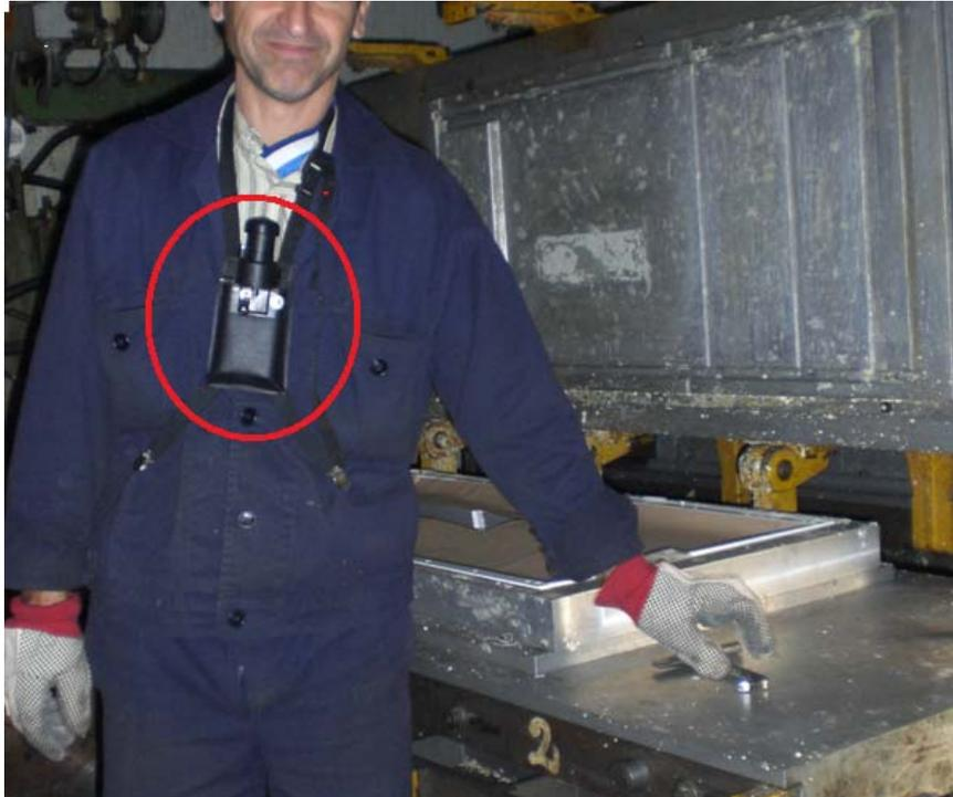
**Fig. V.6 :** injecteur des portes équipé du CIP 10.
