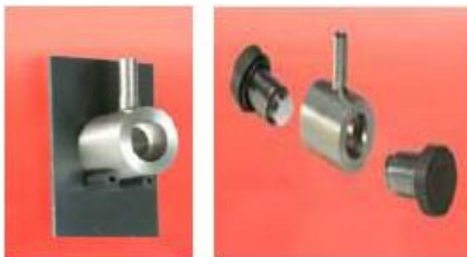
**Figure1 : Presse pour préparation de pastilles fines avec mélange de substance à analyser et sel peu absorbant (FTIR)**
