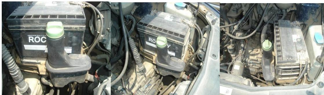
**Figure I.1 : Réservoir d'huile de direction placée dans la voiture**
