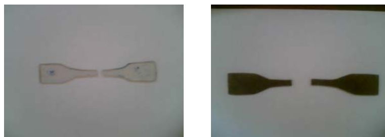
Figure III-9 : éprouvettes après essai de traction, (a) PS pur ; (b) Composite « microcristaux de cellulose/PS » à 9% de charges
