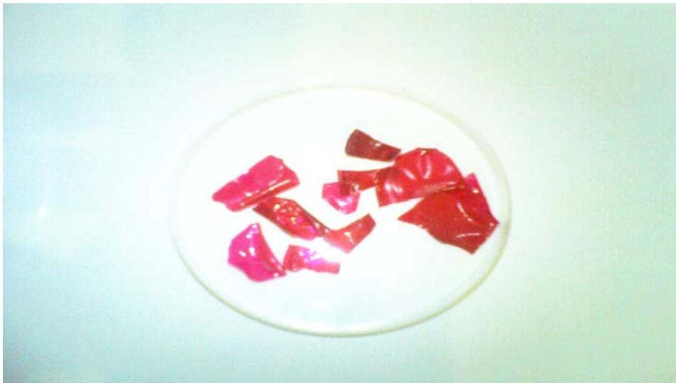
**Figure 16 : les membranes de chitosane pur après l'adsorption du colorant réactif Rouge Bezaktiv**
