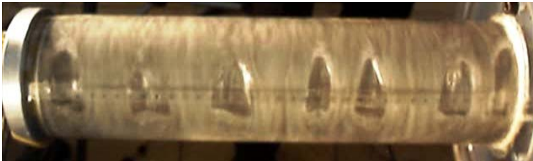
Ta =1228 (poches d'air sous forme des cœurs)
