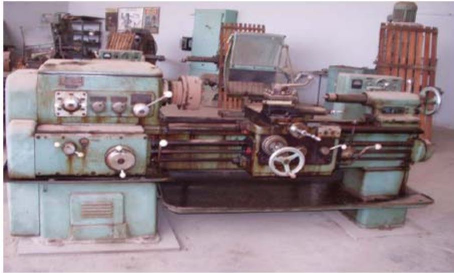
Figure 4.3 Tour utilisé pour la préparation des surfaces étudiées
