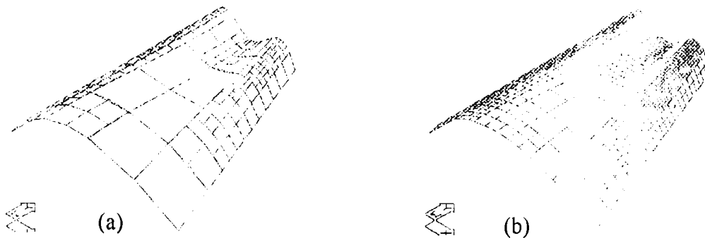
Figure 2.9 Facettisation de la surface avec une tolérance de 0.2mm (a) et 0.02mm (b).
