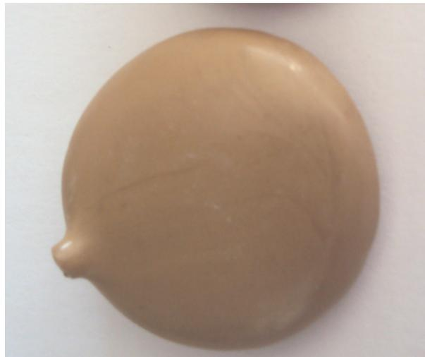
Figure B.II.92: Aspect des vitrocéramiques riches en  $\text{TiO}_2$ .
