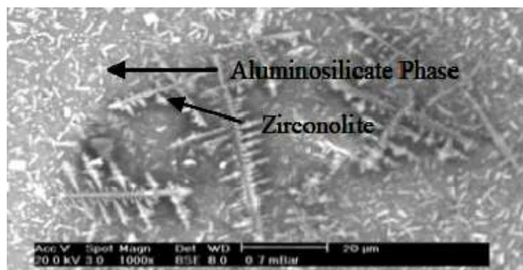
Figure B.II.8: Micrographie MEB de la vitrocéramique avec un rapport Ca/Mg = 2.95 %.
