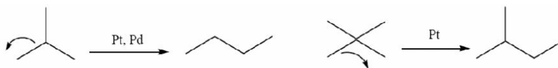
Figure II. 2 : Mécanisme d'isomérisation par déplacement de liaison [14]
