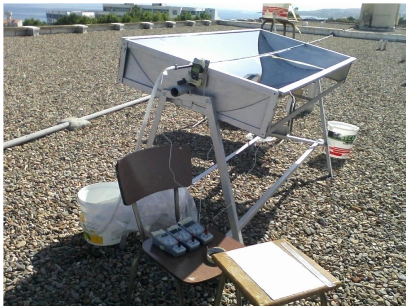
FIGURE VII.9: Vue générale du prototype du concentrateur parabolique.
