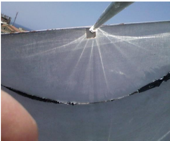
FIGURE VII.6: La tache solaire sur l'absorbeur.
