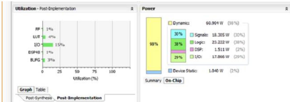
Figure 4.32 : Résultat de l'implémentation d'un filtre Gaussien séparable.
