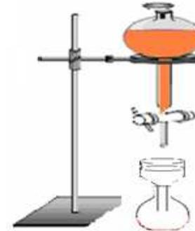
⑤ Ajouter au filtrat 5 mL d'eau distillée et l'introduire dans une ampoule à décanter.
