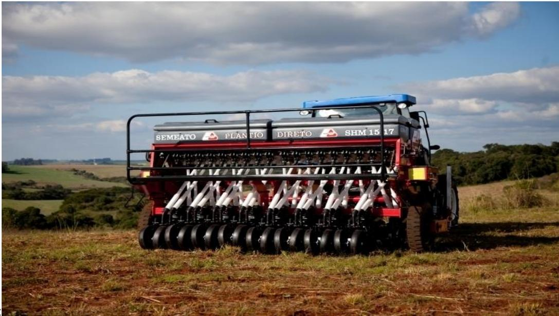
Figure 13 : Semoir direct de la marque SEMEATO d'une largeur de travail de 3 mètres.
