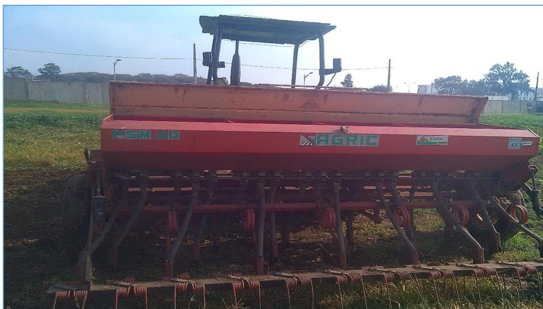
**Figure 12:** Vue sur le semoir en ligne de la marque AGRIC avec largeur de travail 3 mètres, la date de prise de photo au jour de semis (27 /01 /2016).
