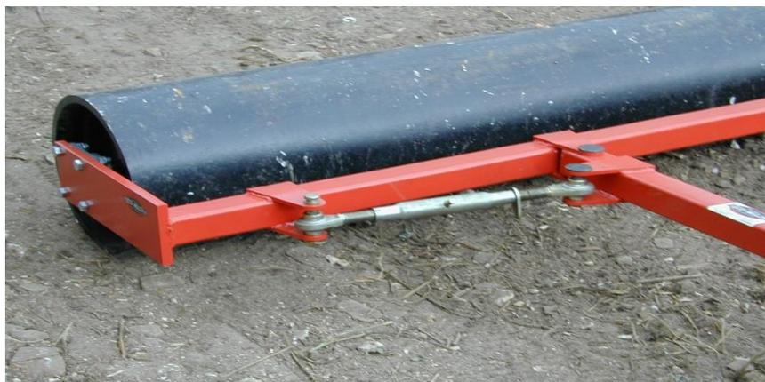
**Figure 9 :** Rouleau lisse pour le tassement du sol après l'opération de semis .
