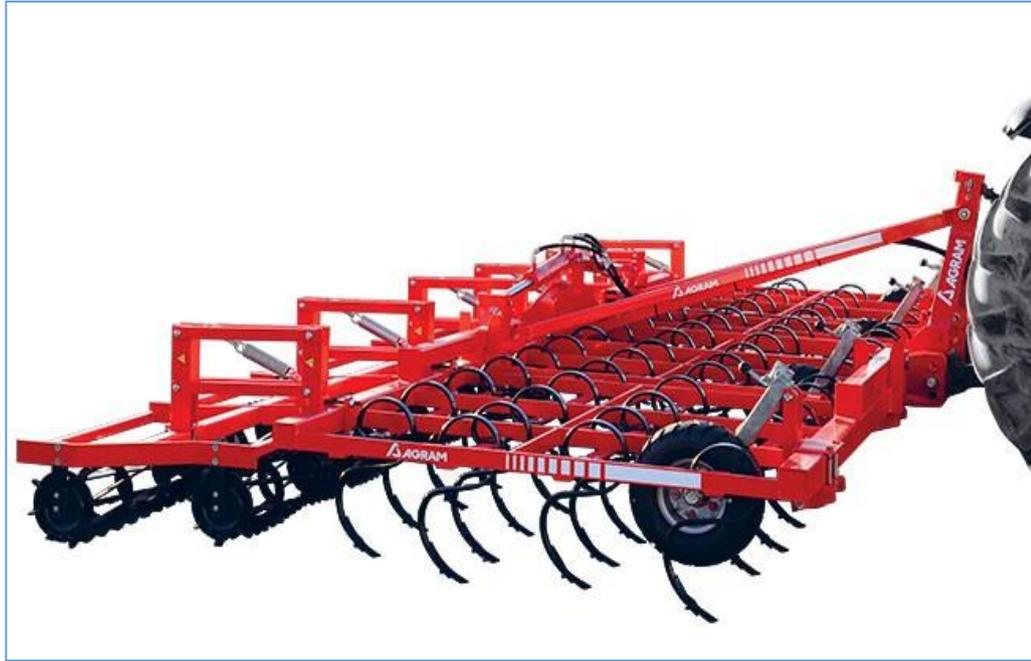
**Figure 10 :** Vibroculteur à dents flexibles (outil a dents).
