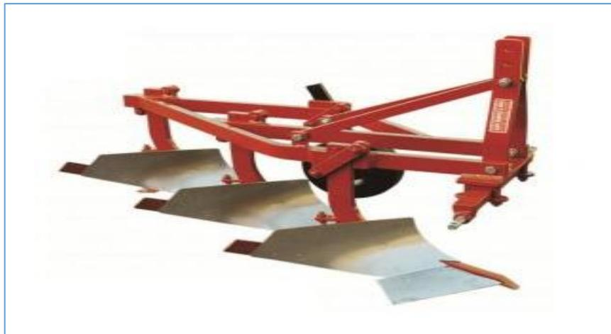
**Figure 7:** Charrue tri- soc pour le labour.
