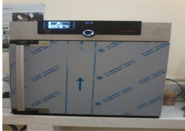
**Fig19:** Evaporation par l'étuve (Original).
