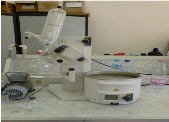
**Fig18:** Evaporation par Rotavapeur (Original).
