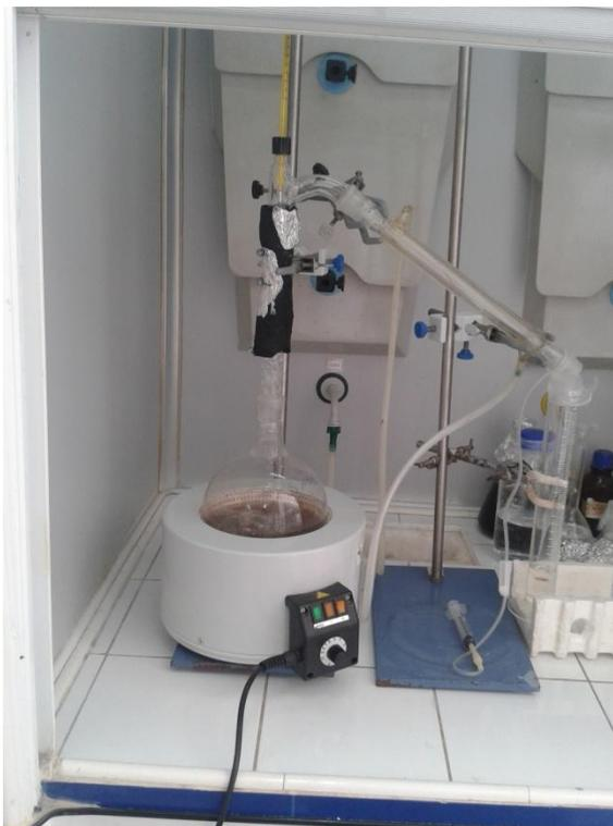
**Figure 14. Dispositif de distillation (Original)**
