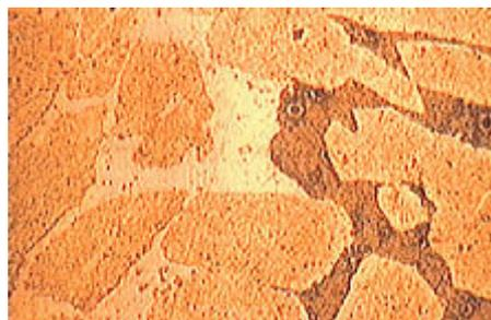
*Figure I- 6 : Coupe métallographique montrant une corrosion sélective d'un laiton*
