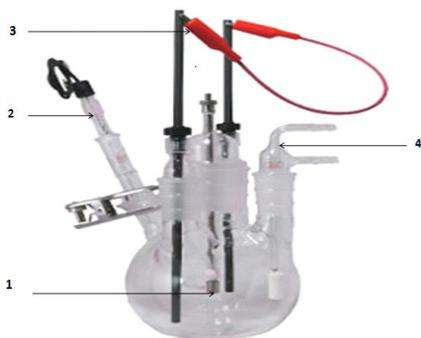
**Figure II-2:** Schéma de la cellule électrochimique.
