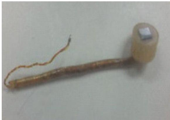
**Figure II-3:** Photographie de l'électrode de travail constitué d'un coupon d'acier
