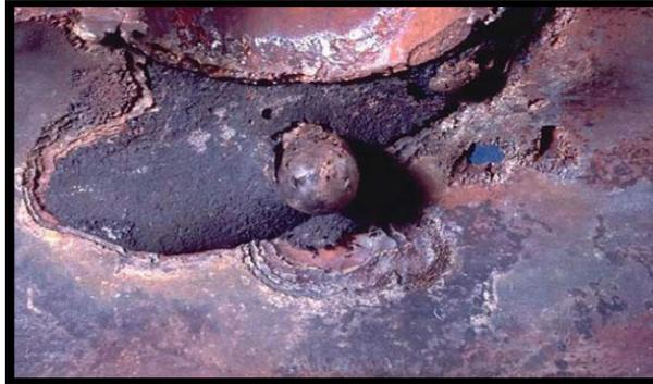
*Figure I-2 a : Corrosion galvanique au niveau d'une zone de brasage entre la brasure Cu-P et le tube en cuivre.*
