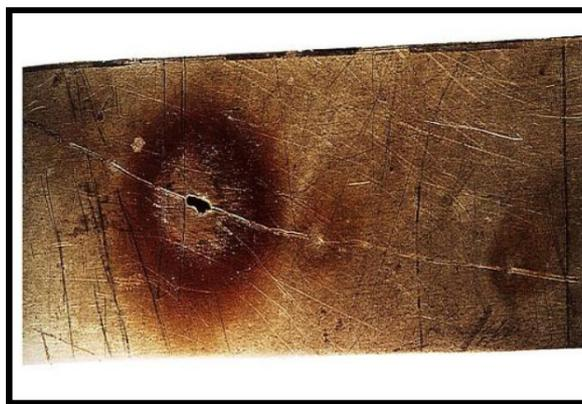
*Figure I-3 : Corrosion par piqûres sur la paroi d'une cuve en acier inoxydable*
