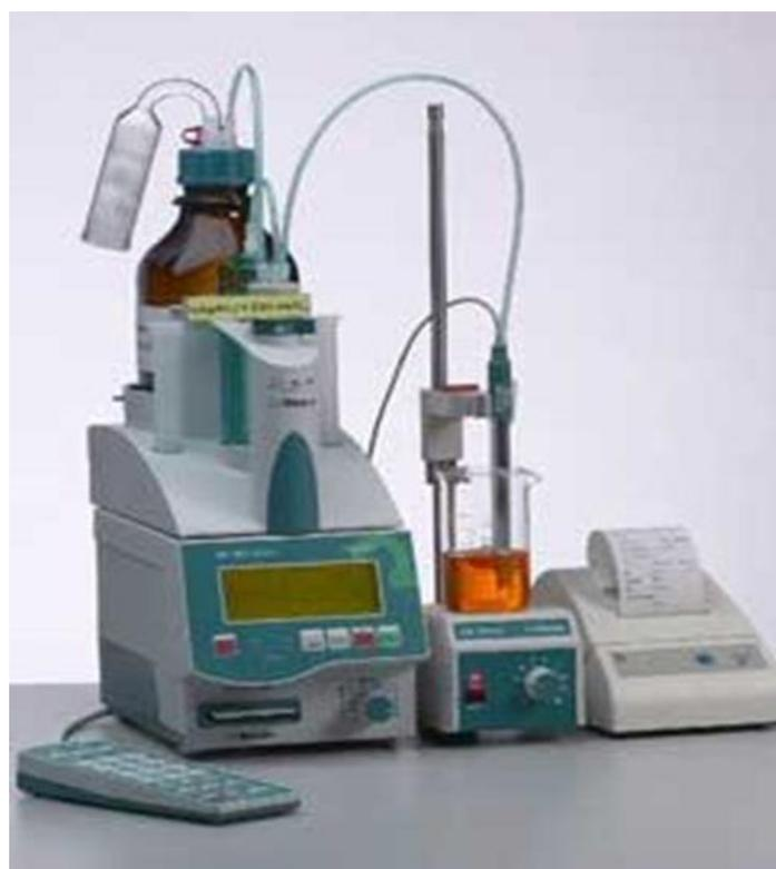
Figures IV.2 : appareil pour détermination de l'indice d'acidité
