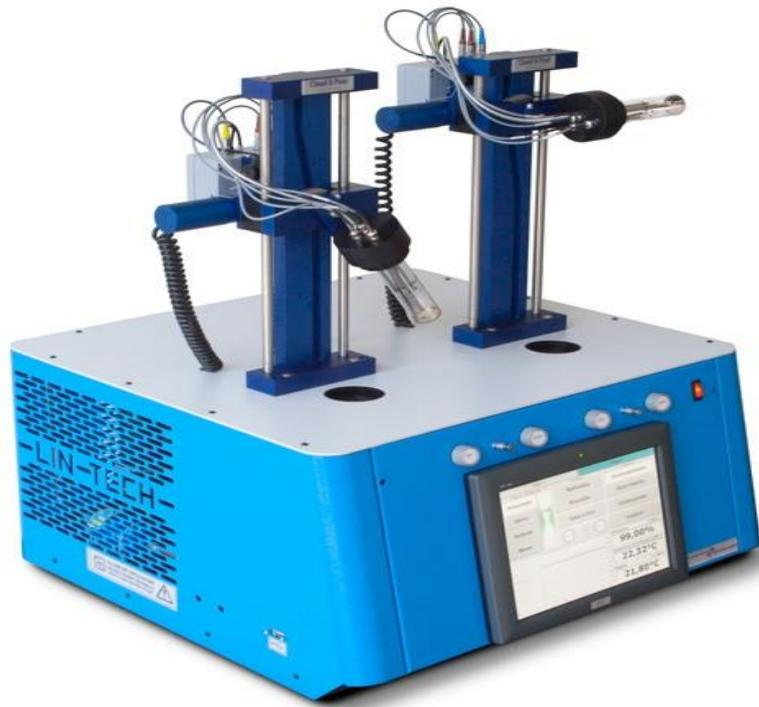
**Figure IV.11. Appareil de détermination de point de congélation et point de trouble**
