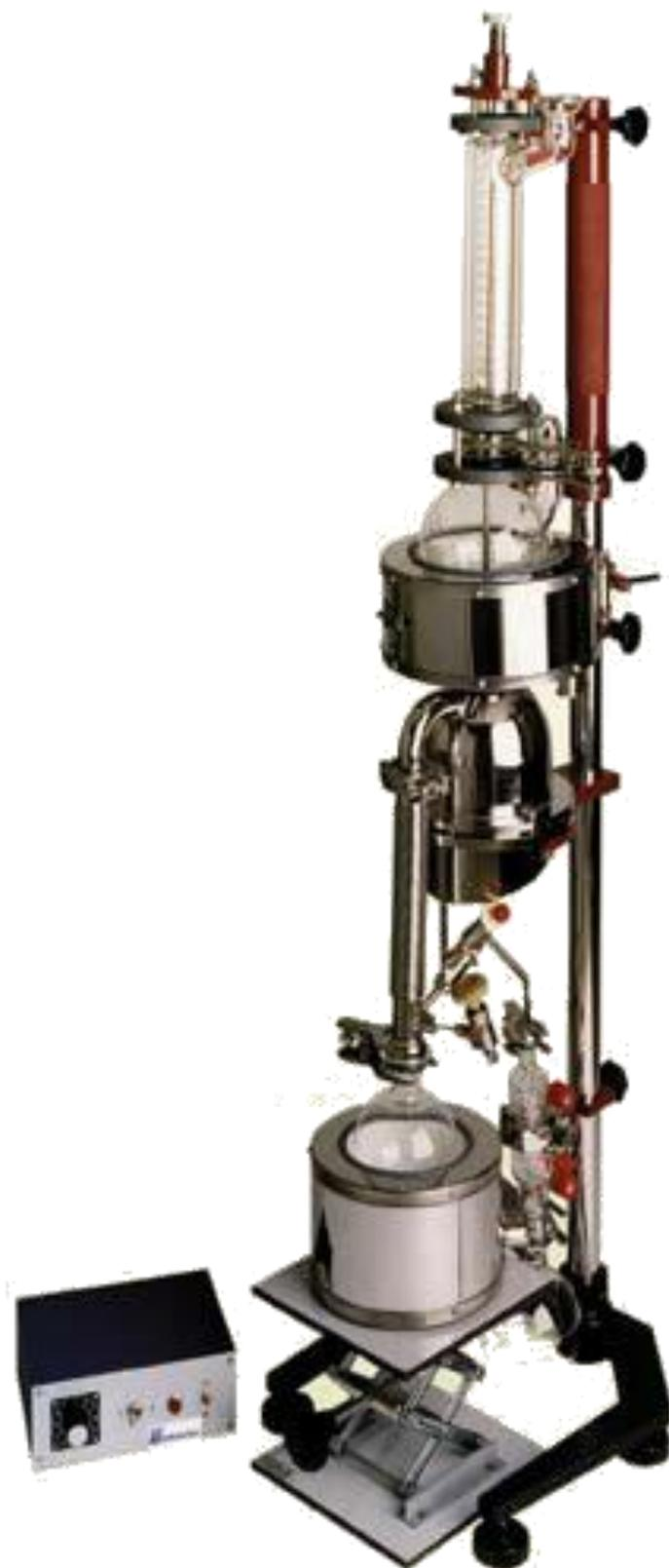
Figure IV.5 : Appareil de détermination de la Teneur en Asphaltènes.
