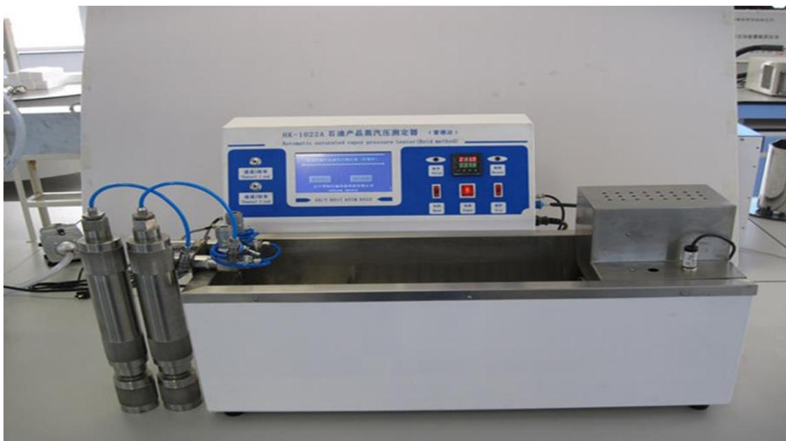
Figures IV.1 : appareil pour détermination de la Tension de vapeur Reid
