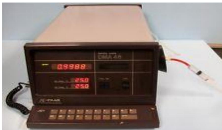
Figure IV.10 : Appareil de détermination de la Densité
