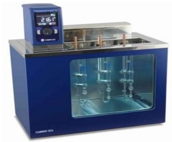
**Figure IV.7 : Bain thermostaté pour la viscosité cinématique manuelle (Type de capillaire : CANNON FENSKE).**
