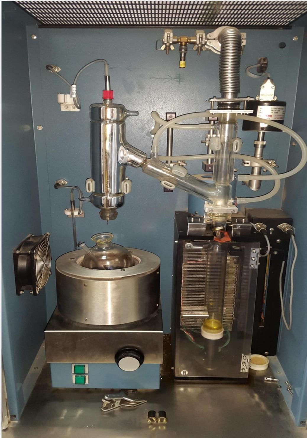
**Figure IV.13 : Appareil semi-automatique de la distillation des produits pétroliers à pression réduites ASTM D1160.**
