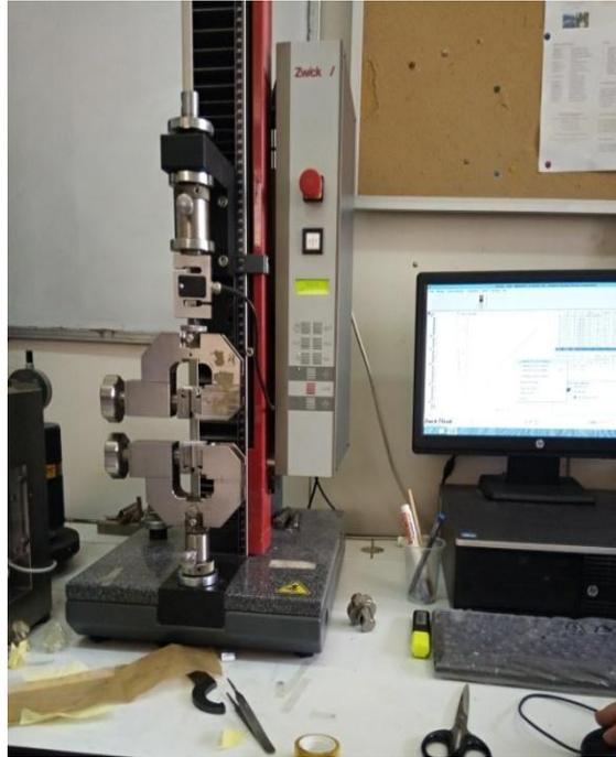
**Figure II.7:** Machine à traction Zwick-roell pour films.
