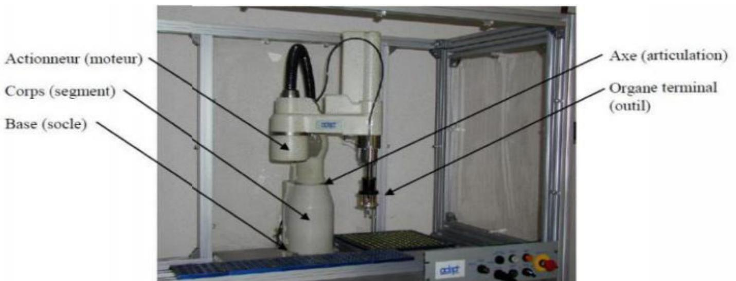
Figure I.4. Architecture d'un robot.
