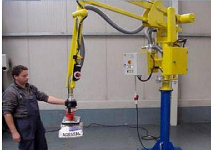
**Figure I.11. Manipulateur à commande manuelle.**
