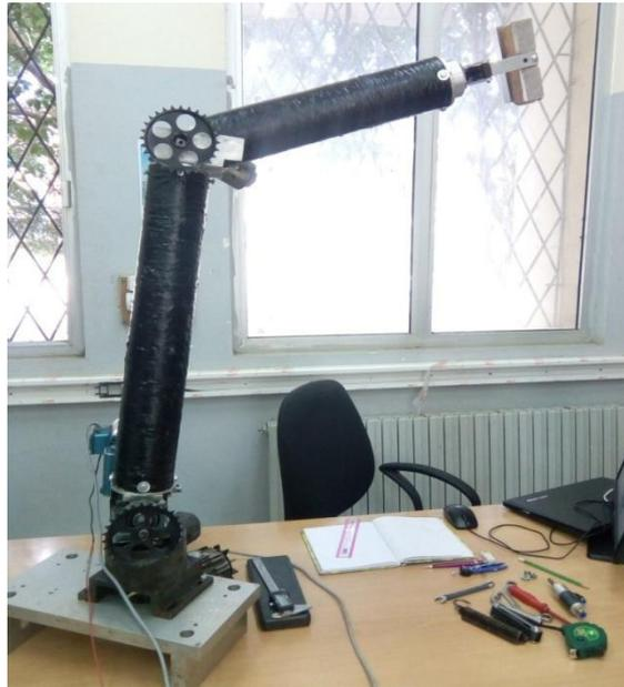
Figure IV.14. Image réel d'un bras manipulateur à RRR.
