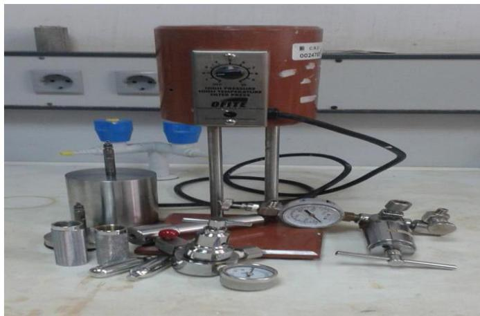
**Figure IV.6:** Filtre presse haute pression- haute température
