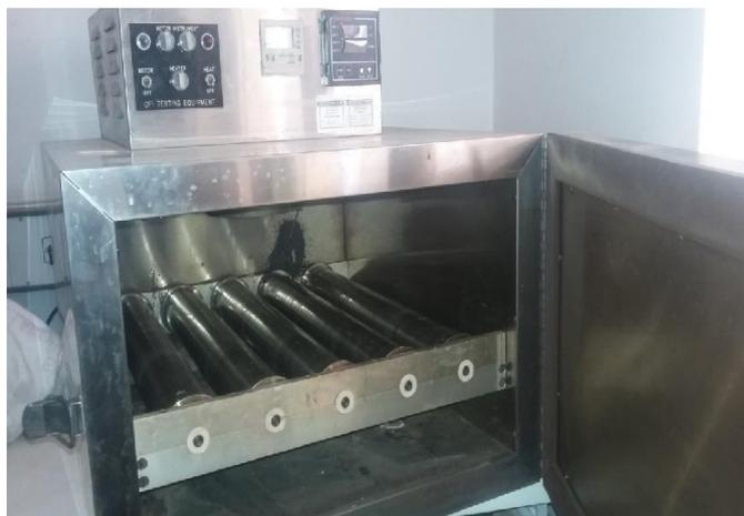
**Figure IV.1:** Cellule haute température et étuve relative (hotrolling)
