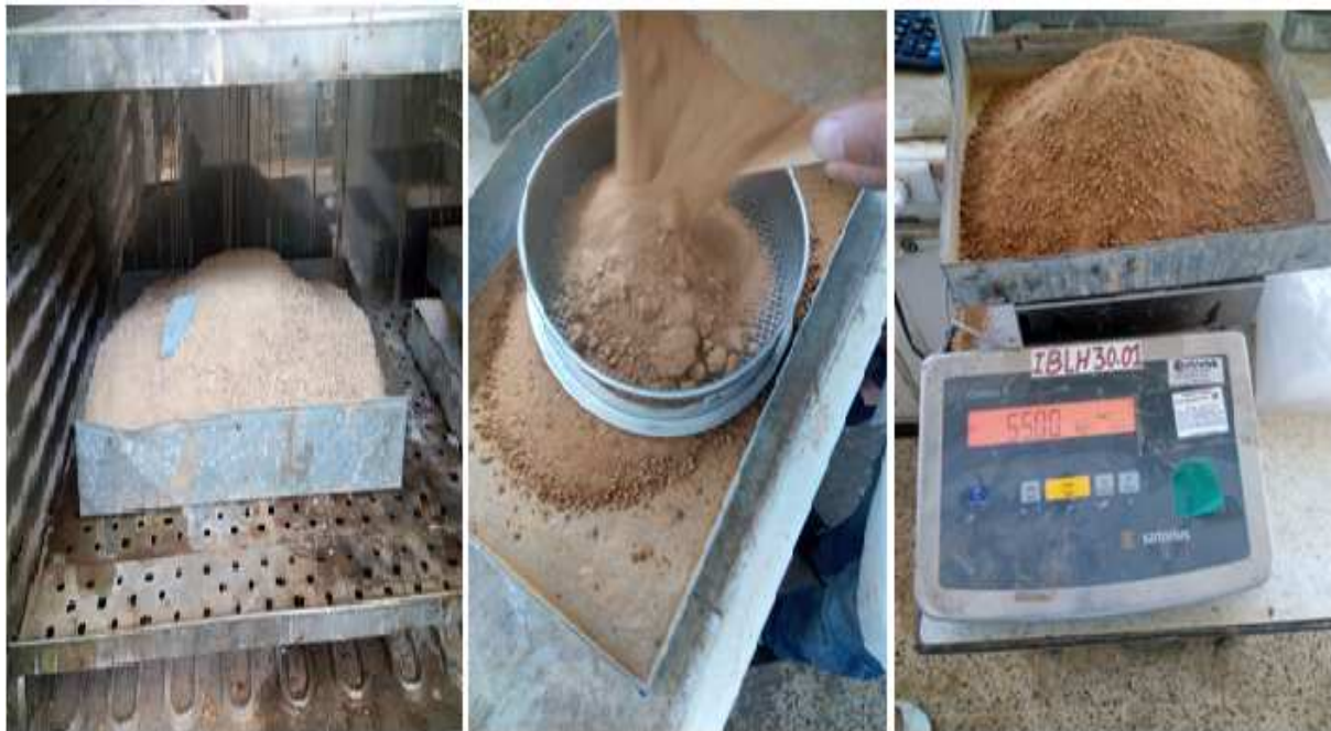
Figure. IV. 7.Préparation de l'echantillon à compacter
