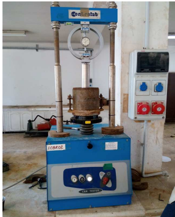
Figure. IV. 9 des moules CBR préparer pour passer au poinçonnement
