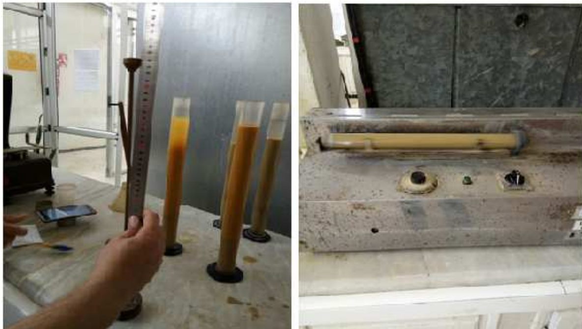
Figure. IV. 4. déroulement de l'essai de l'équivalent de sable
