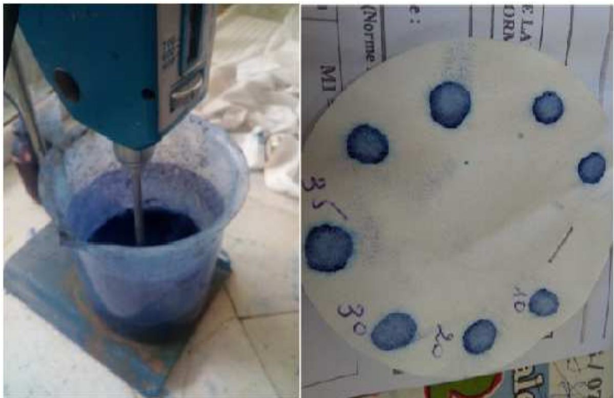
Figure. IV. 5.manipulation de l'essai de bleu
