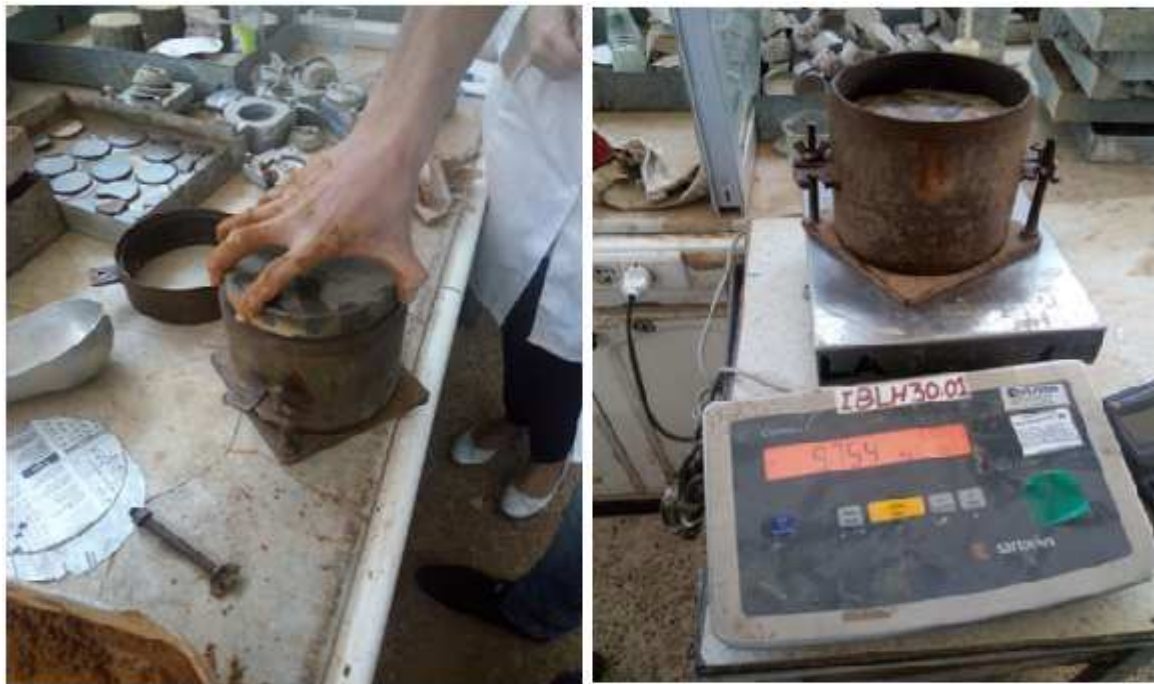
Figure. IV. 8 Réalisation de l'essai Proctor
