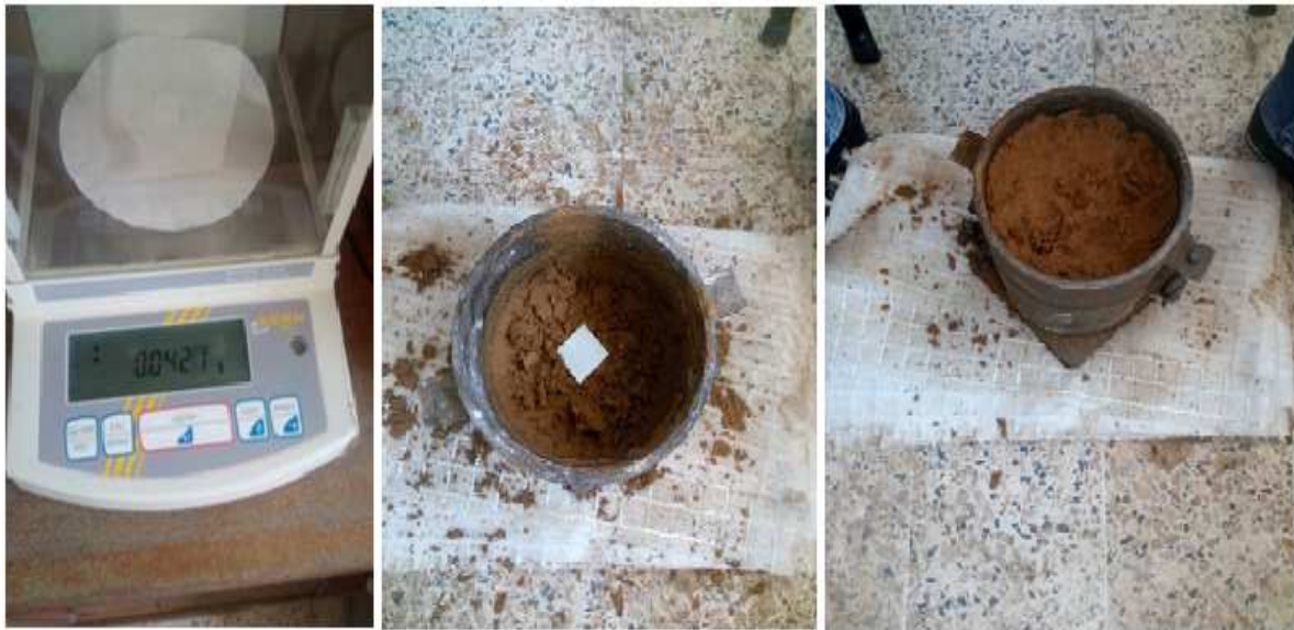
Figure. IV. 11. Réalisation de l'essai de succion
