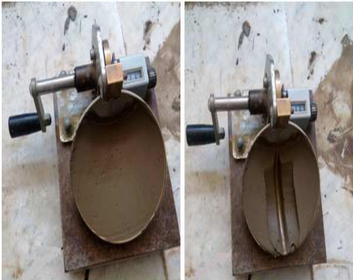
Figure. IV. 2. Réalisation de la rainure dans la pâte de sol au moyen d'un outil spécial
