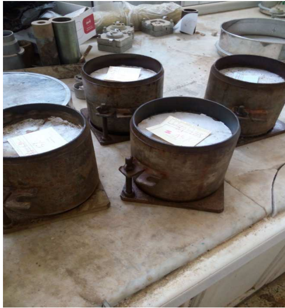
Figure. IV. 9 des moules CBR préparer pour passer au poinçonnement
