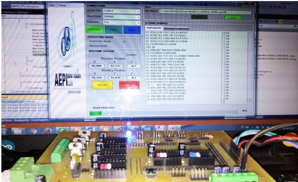
Figure IV.5 : Teste de communication entre le PC et la carte électronique.
