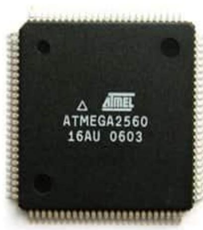
**Figure II.6 :** Photo réelle de l'atmega2560.
