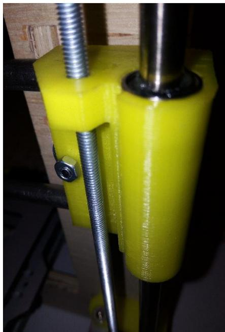
**Figure I.10** : Photo réelle de l'axe Z assemblé.
