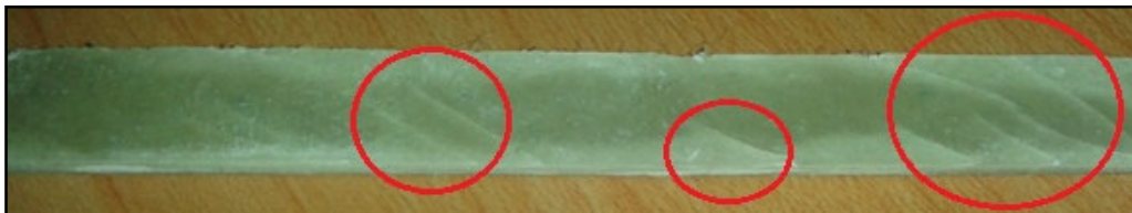
Figure II.4 : Eprouvette de composite à des fissures visuelles à l'œil nues.
