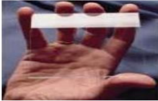
Figure II.12. Verre de vitre avec un revêtement sol-gel poreux anti-réflexion en bas et sans revêtement en haut.
