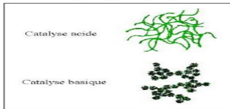
Figure II.10. Différents assemblages possibles des amas polymériques suivant le type de catalyse [18].
