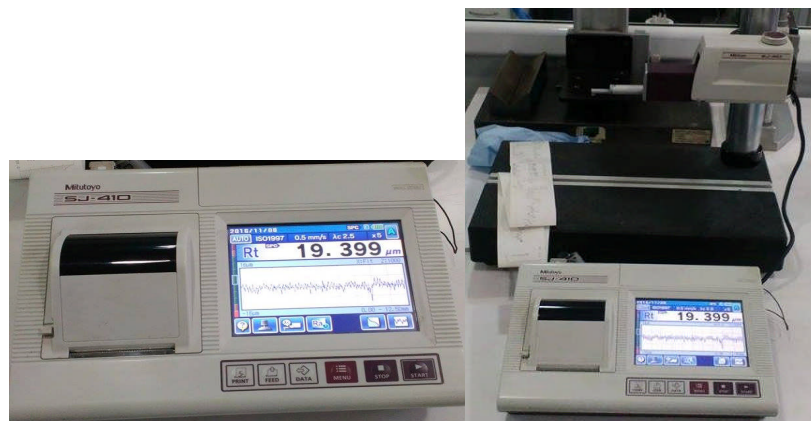
Figure IV.7 Appareil de mesure des états de surface (SURFTEST SJ-410 Mitutoyo)
