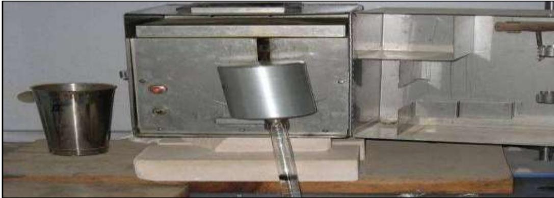
Figure : le distillateur a boue
