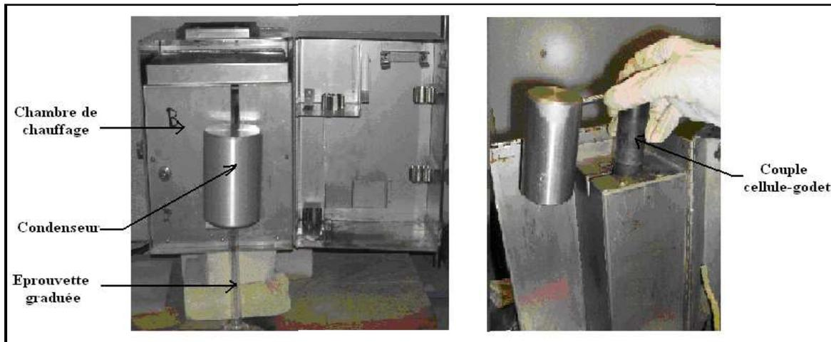
Figure : montage de la cellule avec le godet
