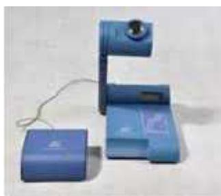
Figure XX : conductimètre (METROHM 712)
