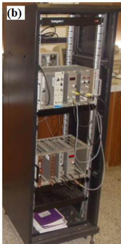
Figure III. 6. (a et b). Dispositif expérimental de la spectroscopie Mössbauer du CRNA et (c). Représentation schématique du montage de la spectroscopie Mössbauer.
