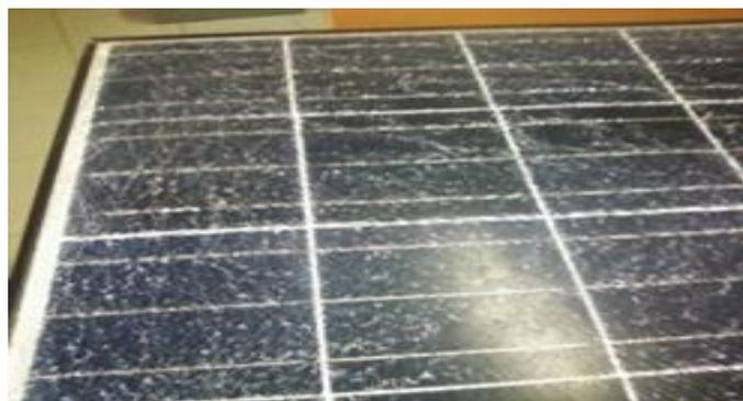
**Figure I-18.** Module photovoltaïque présentant des bris de verre.
