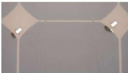
**Figure I-19.** Module présentant des points chauds sur les bords des coins supérieurs.
