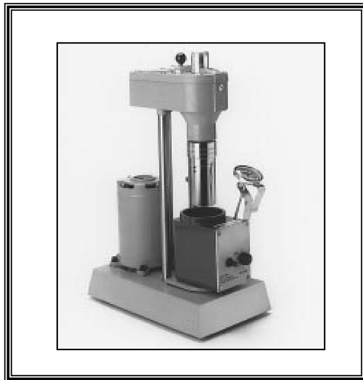
**Figure1:Viscosimètre FANN 35**
