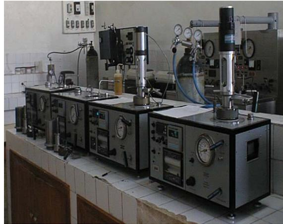
Fig.14. Consistomètre préssurisé
