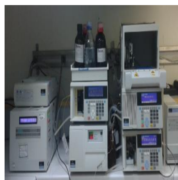
HPLC Perkin Elmer (série 200 Auto sampler) couplée à détecteur à fluorescence
