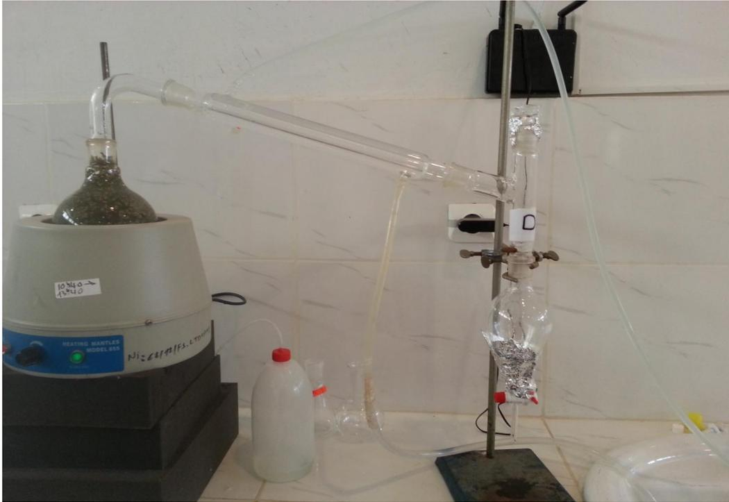
Figure 15 : Appareil expérimental de Clevenger (original)
