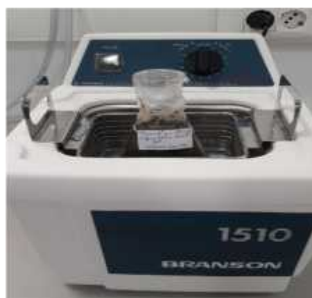
Figure 17 : Extraction assisté par ultrasons des feuilles. (Photo originale).
