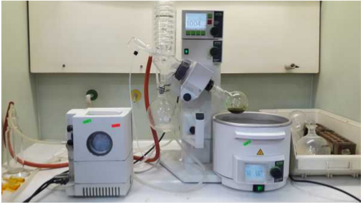
Figure 1 : Evaporation de solution hydroalcoolique par rotavapeur. (photo original) .
