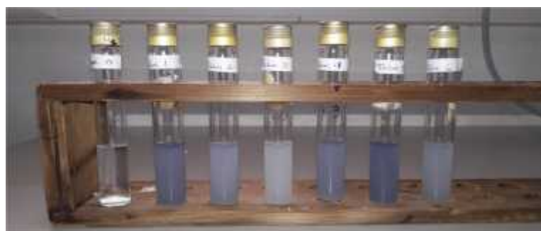
Figure 22: Résultats colorimétrique de dosage des extraits polyphénoliques totaux par folin -ciocalteau. ( Photo originale ).
