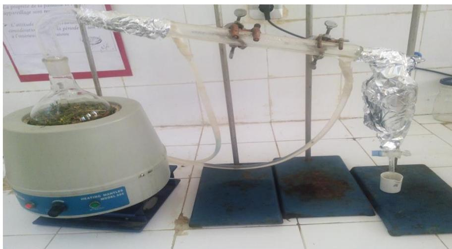
**Fig.8** : dispositif d'hydrodistillation
