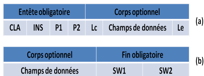
Figure IV.6 : Commande APDU (a) et réponse APDU (b)
