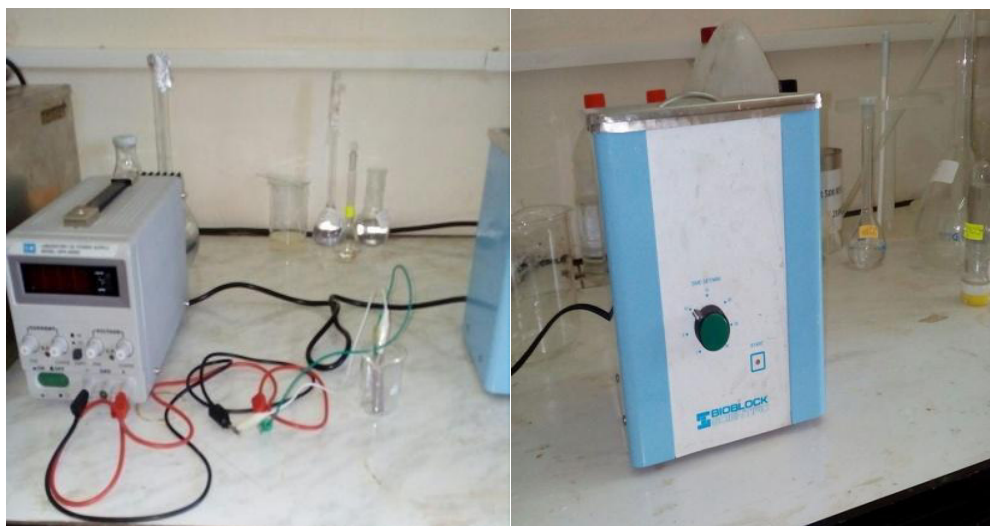
a- Générateur de tension
