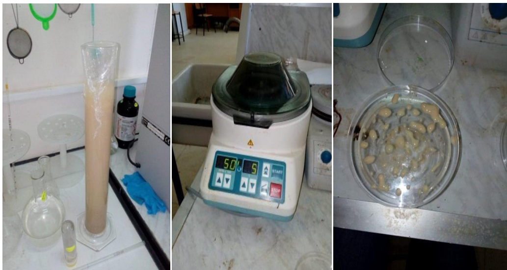
Figure II.8: Sédimentation de la Bentonite et récupération de la montmorillonite suspendue par centrifugation.
