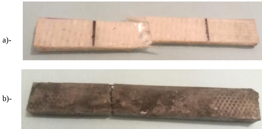
Figure 2-10. Mode de rupture des éprouvettes (a) GFPP et (b) SWPP
