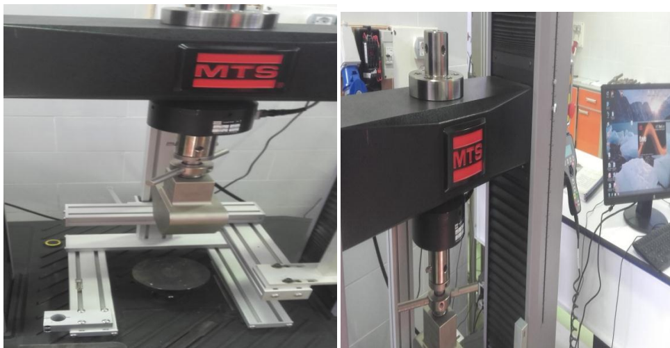
Figure 2-6. Presse électromécanique pour essais mécaniques
