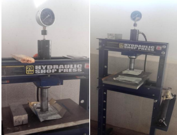
Figure 2-3. Presse de compactage de capacité 20 Tonnes
