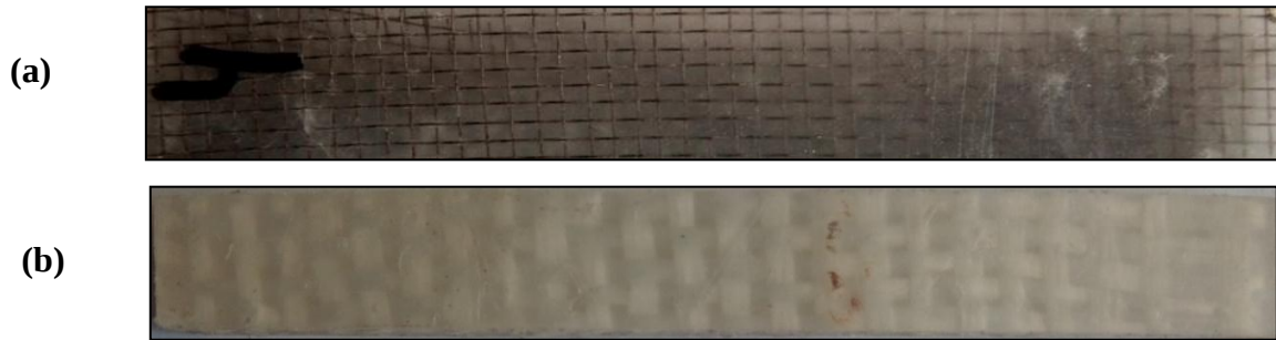
Figure 2-7. Éprouvettes pour essais de traction, (a) SWPP, (b) GFPP
