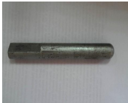
Figure 2-12. Forme hémisphérique de l'indenteur
